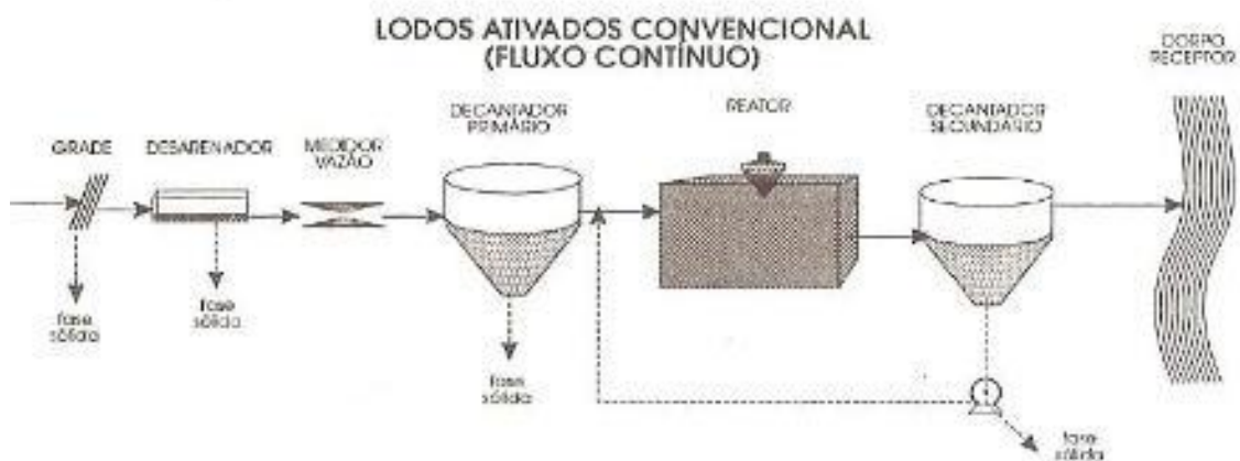
Figura 9.1 12 - Processo de Lodos Ativados Convencional
